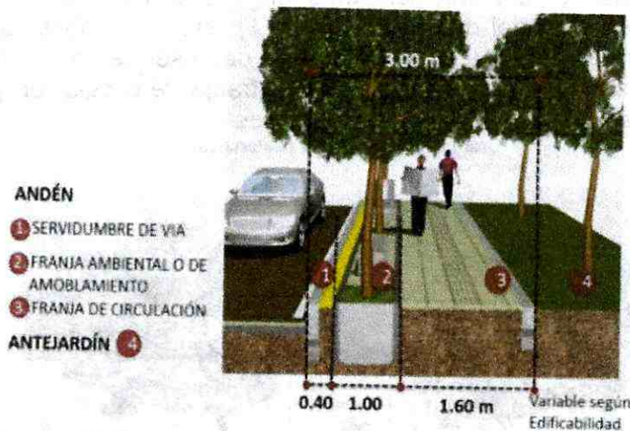
Gráfica N° 6. Sección del andén mínimo en sectores residenciales con franja ambiental (3.00 m).
