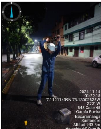
Figura 5 Exploración geofísica mediante sísmica
