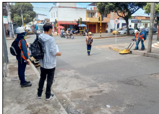
Figura 6 Exploración geofísica mediante georadar
