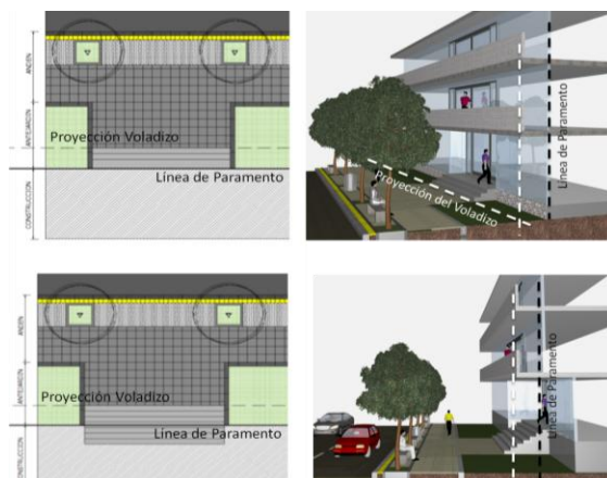
Gráfico 9 DTS POT - Gráfica N° 20. Escaleras de acceso a las edificaciones.
