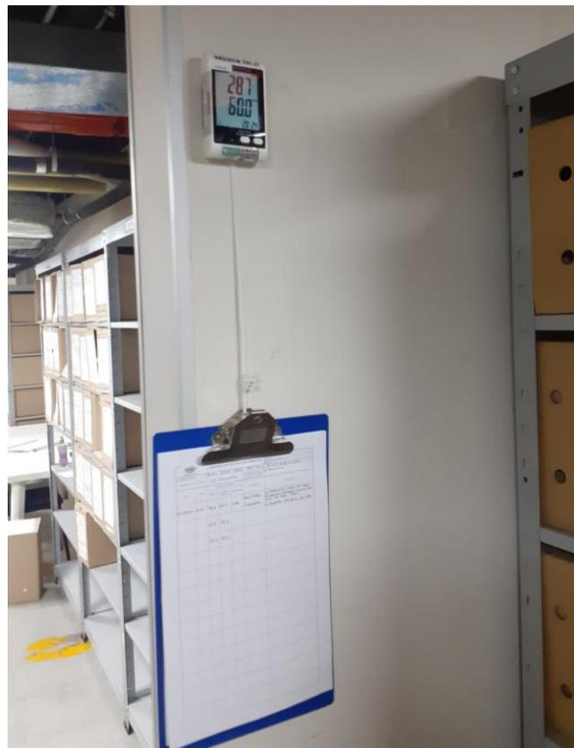
Foto 4. Termohigrómetro y registro de medición de condiciones ambientales en la bodega.
