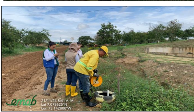
Ilustración. Lectura de Piezómetros de sonda geoelectrica
