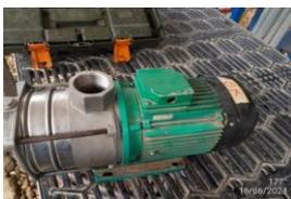
Reemplazo del sello mecánico de la bomba de recirculación DAF
