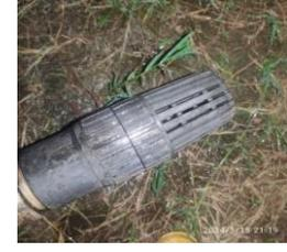
Limpieza de las válvulas de pie del pozo y tanques de alimentación y salida DAF
