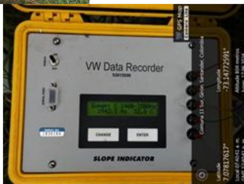
Ilustración 5 Lectura de Piezómetros de hilo vibrátil
