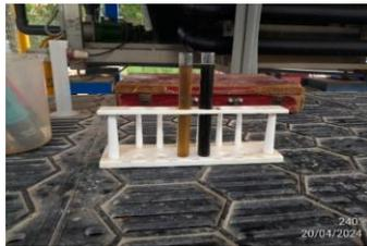
Medición de sólidos suspendidos totales (SST) en la entrada y salida DAF
