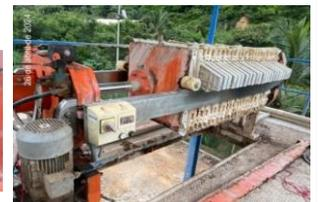
Mantenimiento del filtro prensa-Reemplazo de rieles
