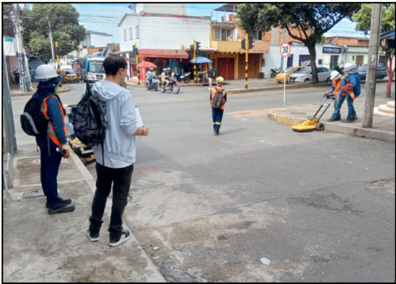
Figura 6 Exploración geofísica mediante georadar
