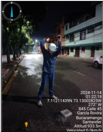
Figura 5 Exploración geofísica mediante sísmica
