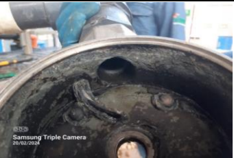
Reemplazo bomba DAF3 por bomba DAF1- falla del sello mecánico
