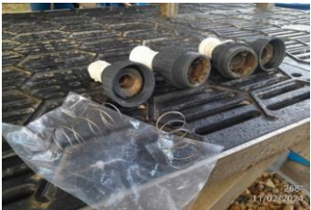
Reemplazo resortes de las válvulas antirretorno ubicadas en la zona de inyección de químico del DAF
