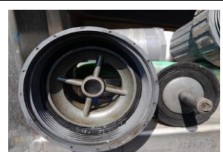
Reemplazo de la válvula de retención ubicada en el circuito de recirculación del DAF
