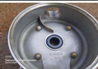
Reemplazo bomba DAF3 por bomba DAF1- falla del sello mecánico
