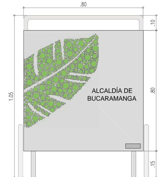
Imagen 71: Fachada puesto de venta semi-estacionario tipo 1. Esc 1:15
