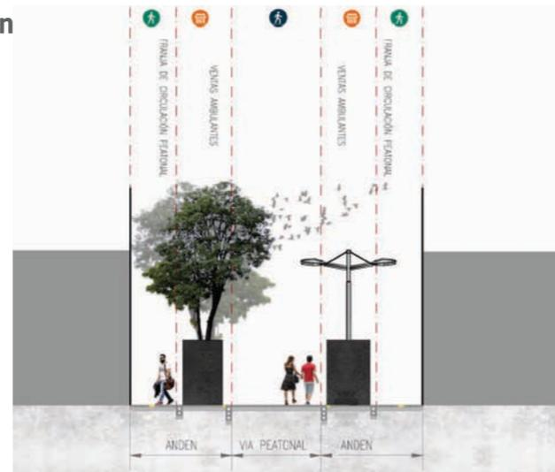
Imagen 21: Sección esquemática de calle peatonal con espacio para puestos de venta regulados. Estos esquemas son de carácter ilustrativo y no implican ningún diseño específico
