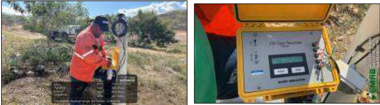
Ilustración 36 Lectura de Piezómetros de hilo vibrátil
