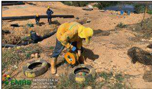
Ilustración 37 Lectura de Piezómetros de sonda geoelectrica
