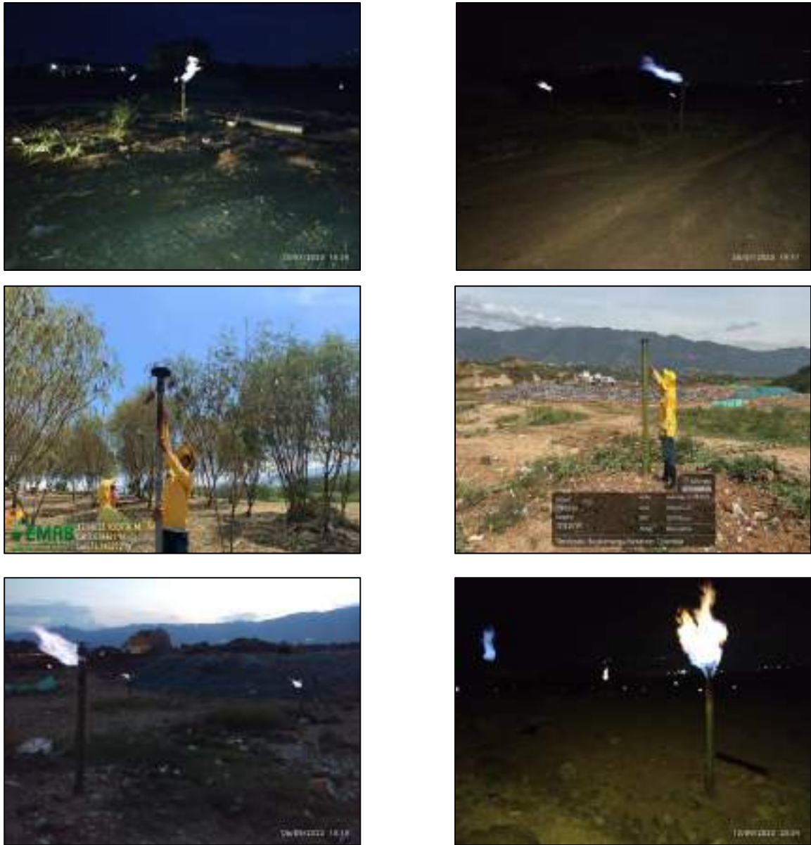
Ilustración 23 Verificación de chimeneas encendidas en el recorrido nocturno.
