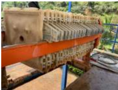
Cambio de las telas del filtro prensa por unidades nuevas (Febrero/2023)
