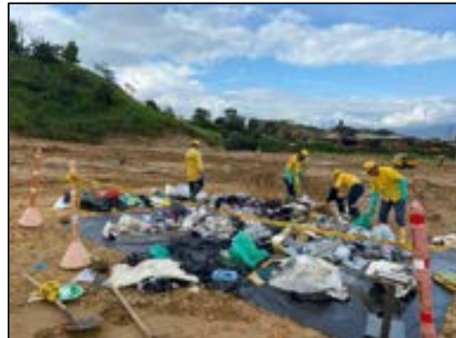
Ilustración 25 Clasificación de residuos según su composición física
