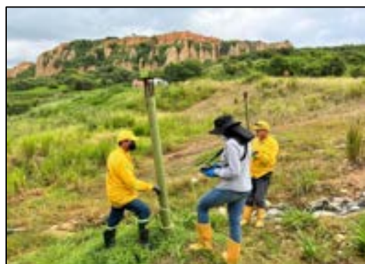
Ilustración 36 Caracterización de biogás celda de respaldo
