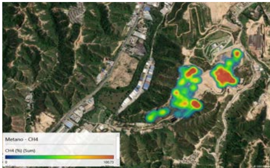
Ilustración 37 áreas con concentración de metano – CH4
