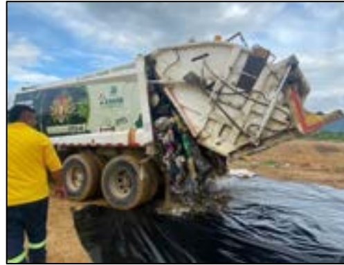
Ilustración 23 Vehículo compactador descargando la muestra
