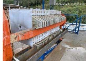
Reemplazo de telas de los paneles del filtro prensa (Por presencia aumento de rigidez dificultando acople en el panel)
