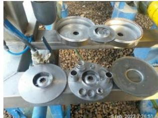
Mantenimiento a las tapas de las bombas dosificadoras del DAF.
