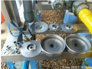
Mantenimiento de la bomba de recirculación del DAF (para evitar incrustaciones en impulsores y difusores)
