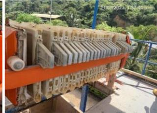
Limpieza de las telas y paneles del filtro prensa (Por acumulación de sedimentos en poros)
