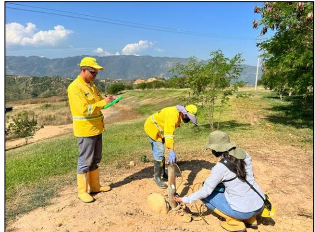
*Ilustración 26 Caracterización de biogás celda de respaldo 1.*
