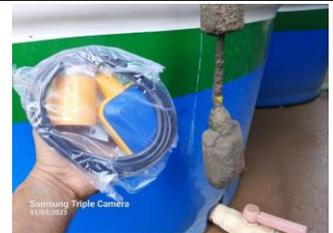
Reemplazo del flotador del tanque de concentrados (por falla en mecanismo)
