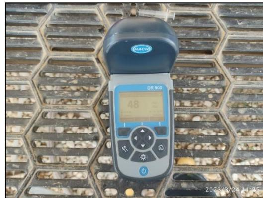
*Ilustración 30 SST entrada y salida DAF*
