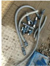
Limpeza del circuito de recirculación del DAF (cheques, Venturi, mangueras de conducción)
