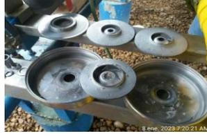
Mantenimiento de la bomba de recirculación del DAF (Para evitar incrustaciones en impulsores y difusores)
