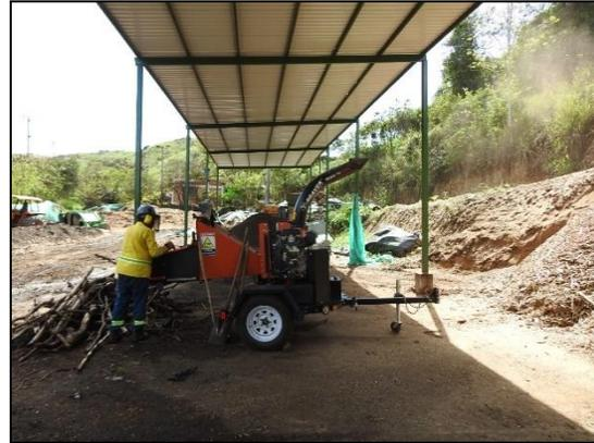
*Ilustración 35 Chipeado de la fracción vegetal de podas y rocería*
