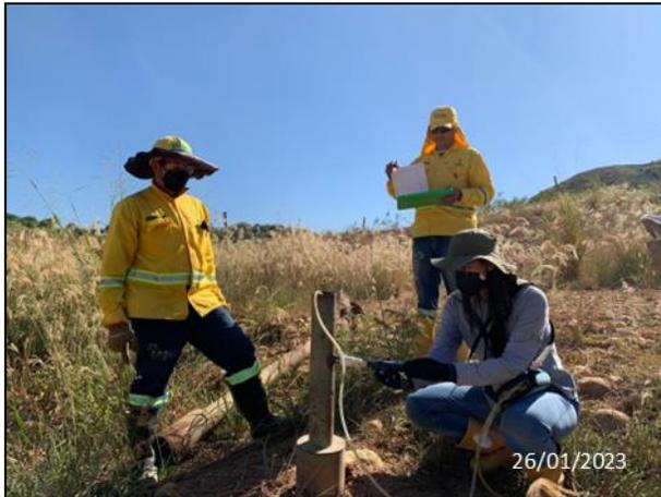
*Ilustración 25 Caracterización de biogás celda de respaldo.*
