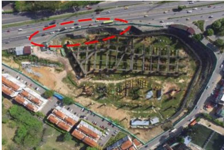
Fig.1. Foto Actual del Lote en donde se observa que la estructura en concreto del proyecto del Portal de Floridablanca y la excavación y columnas invaden el carril de la paralela de la autopista.
