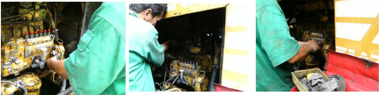
**MONTAJE DE BOMBA DE INYECCION CALIBRADA Y REPARADA POR
