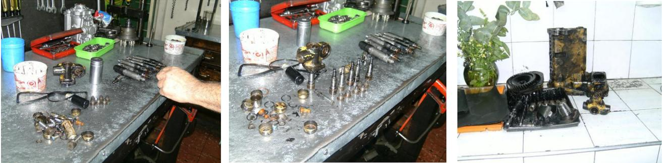
**BOMBA DE INYECCIÓN DEL CARGADOR FIAT ALLIS FRM12 DESARMADA EN LABORATORIO SUR DIESEL PARA CALIBRACIÓN Y MANTENIMIENTO GENERA**
